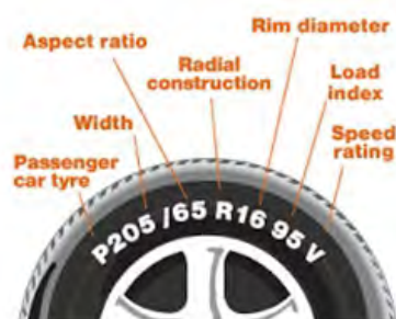
Fig. 1.4.7. Tyre sidewall coding
